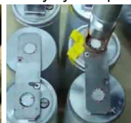
Сварка литиевых аккумуляторов
