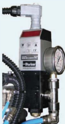
Арт. 8240 Пропорциональный клапан. Позволяет управлять усилием сжатия между электродами во время сварочного цикла. Управление пропорциональным клапаном осуществляется с блока управления, что позволяет соблюдать правильные усилия сжатия для каждой программы или детали.
