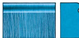
ВОГНУТАЯ ПОВЕРХНОСТЬ РАЗРЕЗА ПОД ВЕРХНЕЙ КРОМКОЙ
