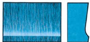
ВОГНУТЫЙ ПРОФИЛЬ ПОВЕРХНОСТИ РАЗРЕЗА
