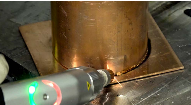
Прочная и герметичная сварка медной трубы толщиной 2 мм к медному фланцу толщиной 3 мм
